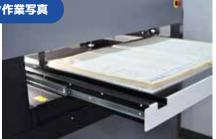
当社がこの度導入したスキャナの特徴は、原稿を傷めない立体上面スキャンにて行ないますので、古くなって製本が綻びたりしているものでも、厚さが10cm・重さ20kg・A-1 サイズまで対応いたします。
